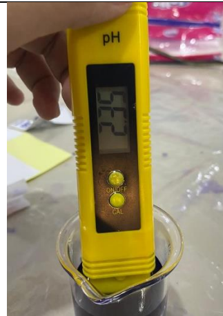
Pengukuran pH larutan turk modifikasi pada H-4
