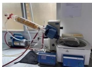
Pemisahan pelarut penyari dengan menggunakan *rotary evaporator*
