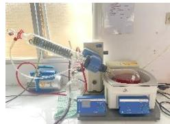
Proses pemisahan pelarut dengan senyawa menggunakan *rotary evaporator* dengan suhu 55 °C
