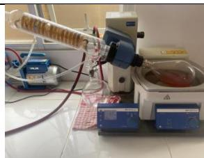
Proses pemisahan pelarut dengan senyawa menggunakan *rotary evaporator* dengan suhu 50°C
