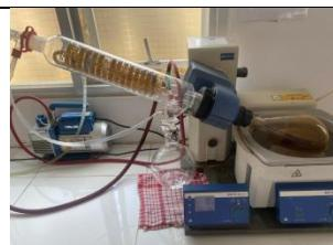
Proses pemisahan pelarut dengan senyawa menggunakan *rotary evaporator* dengan suhu 50°C
