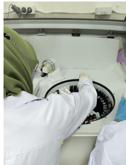
Gambar 10. Memasukkan sampel kedalam alat Biosystems BA200
