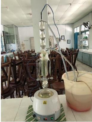
*Soxhletasi* dilakukan hingga pelarut bening
