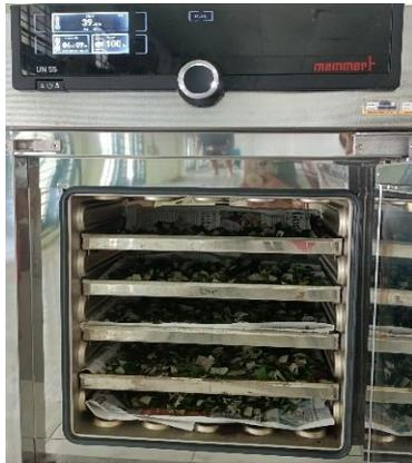
Pengeringan daun balik angin dilakukan dengan oven pada suhu 50<sup>0</sup>C
