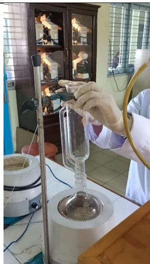
Merangkai soxhlet dan memasukan serbuk simplisia kedalam selongsong.
