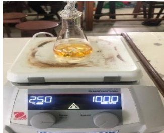
Pemanasan media di atas alat stirrer
