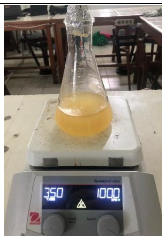
Pemanasan media di atas alat stirrer
