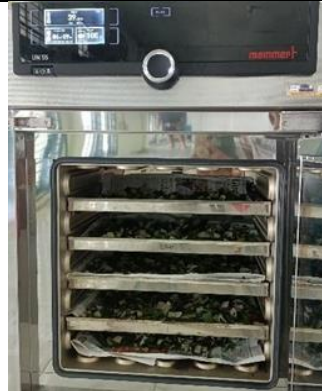
Pengeringan Daun Balik Angin menggunakan oven dengan suhu 40°C.
