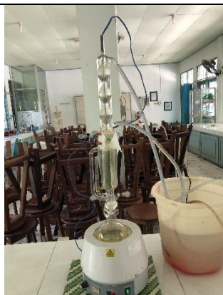
Sokhletasi dilakukan hingga pelarut bening.
