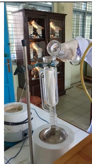
Penambahan pelarut metanol ke dalam selongsong.
