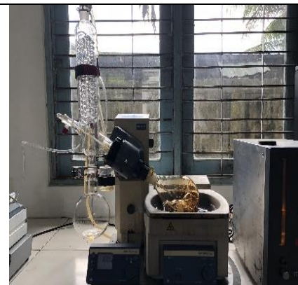
Proses evaporasi ekstrak cair.
