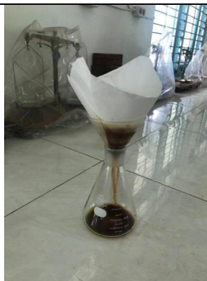
Disaring menggunakan kertas saring agar partikel-partikel kecil tidak ikut.
