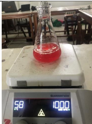
Pemanasan media di atas alat stirrer
