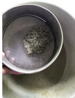
Hasil serbuk simplisia diayak menggunakan ayakan mesh 40.
