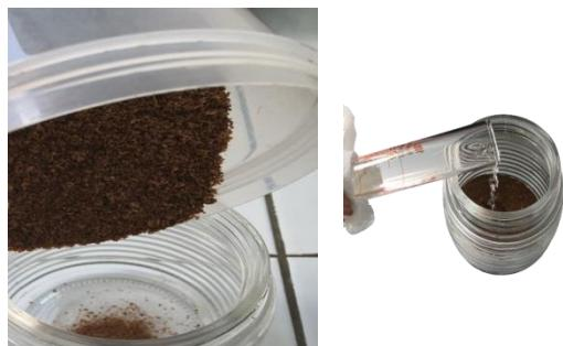
( Proses pengadukan ekstraksi setelah itu bungkus toples menggunakan almuniun foil, menggunakan metode maserasi )
