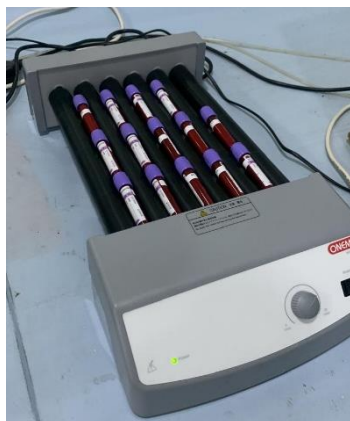
Gambar 5. Proses Pengomogenan Menggunakan Roller Mixer
