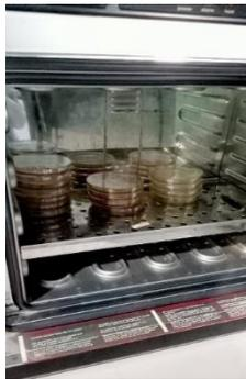
Inkubasi sampel pada temperatur  $36^{\circ} \pm 1^{\circ}\text{C}$  selama 24-48 jam dengan posisi terbalik.
