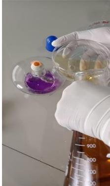
Pembuatan media dengan cara tambahkan 15-20 ml PCA yang sudah didinginkan hingga temperatur  $45^{\circ} \pm 1^{\circ}\text{C}$  pada tiap-tiap cawan berisi suspensi, lalu ratakan.
