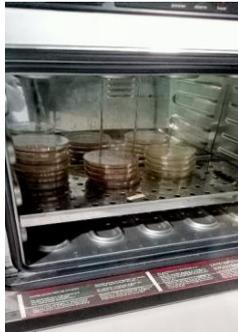
Inkubasi sampel pada temperatur  $25^{\circ} \pm 2^{\circ}\text{C}$  selama 5 hari.
